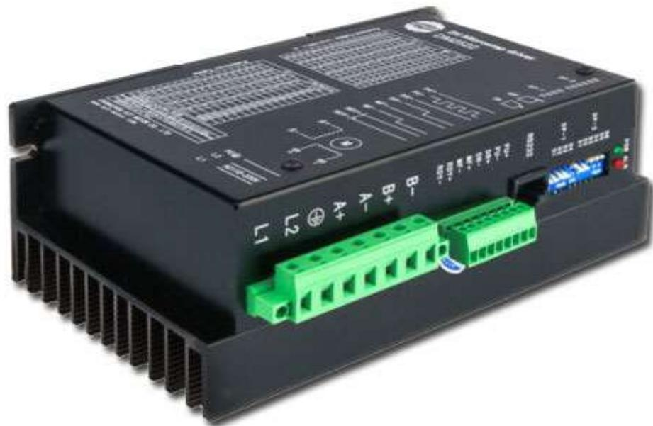
Der Stromanschluss erfolgt an der unteren 7 poligen Schraubklemme. Die Klemmen L1 - L2 und das Symbol für den Schutzleiter sind auf dem Gehäuse aufgedruckt. Somit sind falsche Anschlüsse fast ausgeschlossen.
